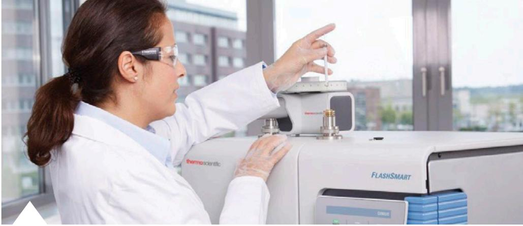
nación de Nitrógeno y Proteína en varias muestras de cereales y legumbres, para validar el sistema en distintas condiciones de contenido total de Nitrógeno y Proteína. Los datos muestran una excelente reproducibilidad: en todos los casos, la desviación estándar fue menor que 2%, en cumplimiento de la normativa AOAC 990.03 para alimento animal. No se observó ningún efecto memoria al cambiar la muestra, lo que significa una completa detección del Nitrógeno presente en la muestra.
